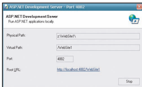
Figura 3. Cassini, el servidor web incorporado en Visual Studio y VWD, permite ejecutar aplicaciones sin necesidad de instalar y configurar el IIS. Al trabajar sobre un puerto al azar, no interfiere con otros servidores instalados.
